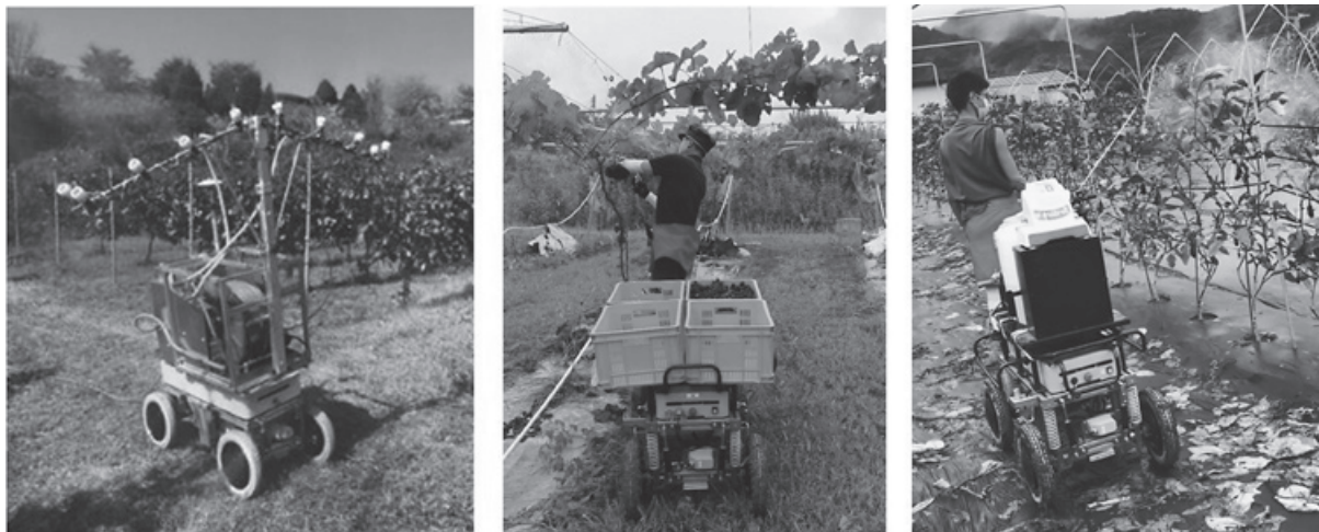
図4 多機能型農業ロボットDONKEY（農林水産省実証事業における実証機）
